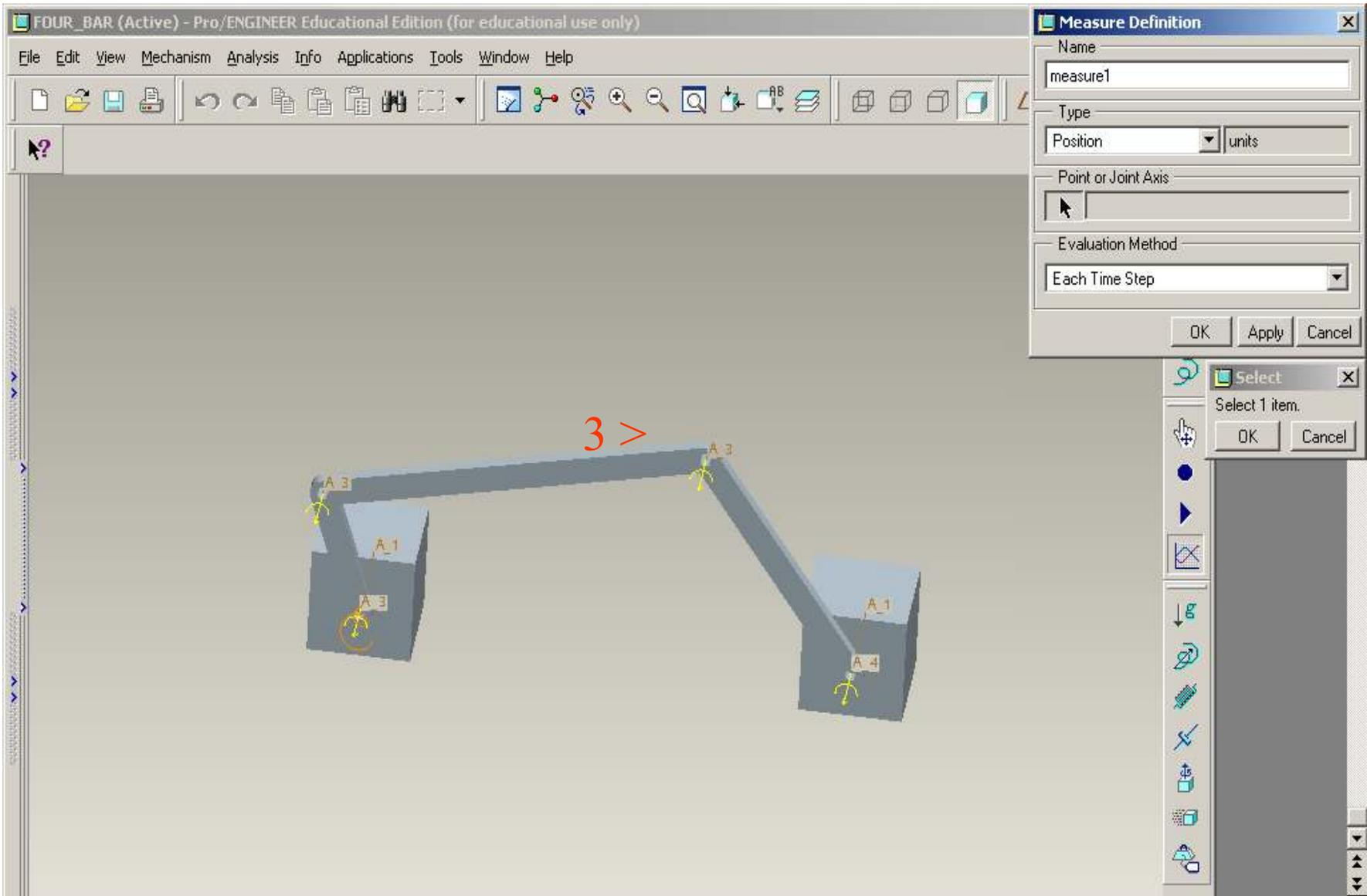
Use default name **measure1**. Select **Type** of parameter > **Position** > select the **JOINT 3** axis > OK.
